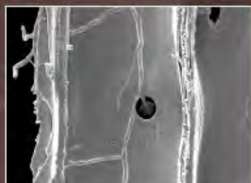
Obr. 8.9 Rupčúra v bunkovej stene jarnej tracheidy (P3)
