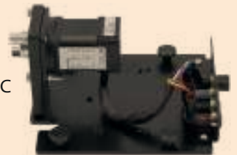
Bezkartáčový jednosmerný motor/3-fázový generátor
