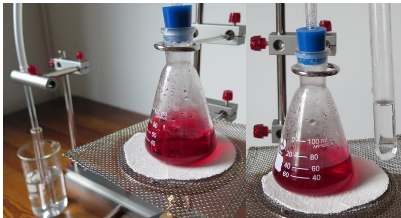
obr.č.7,8 Destilácia zafarbenej vody
